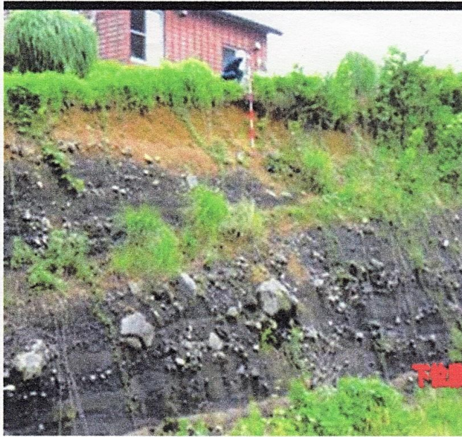
下位段丘の上町面で観察された段丘礫層(本町通り工事現場)
